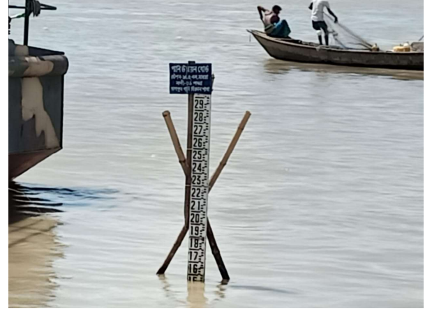
চিত্রঃ পানি সমতল গেজ স্টেশন
